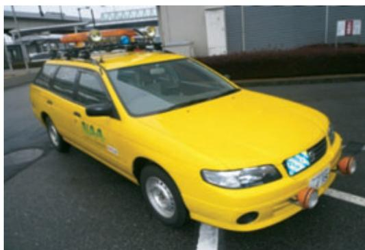
生が疑われた場合、航空会社より空港会社に一報が入る。空港会社は、当該滑走路を一時閉鎖し、滑走路面に鳥の死骸、部品など落ちていないかの安全点検を図5に示すパトロー
