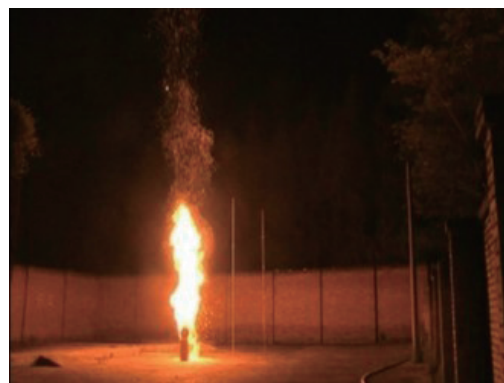
再現実験 固体ニトロセルロース 40 kg 入り容器
