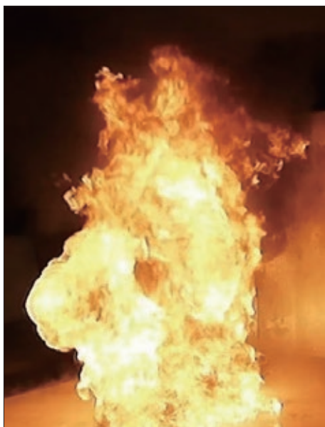
図1 ガソリンの着火燃焼状況
