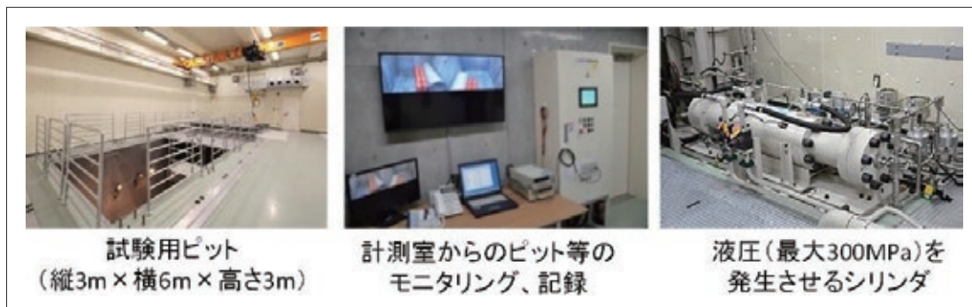
図4 液圧による容器のサイクル/破裂試験等を実施する設備の一例
