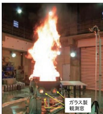
図5 燃料油面を泡消火薬剤が被覆している様子
