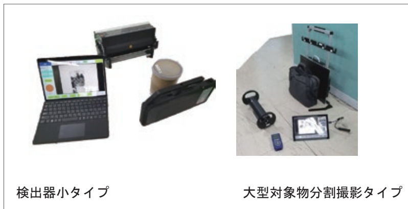
図3 可搬式 X 線検査システム
