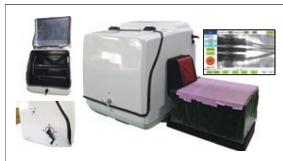
図8 回転式 X線検査装置システム
