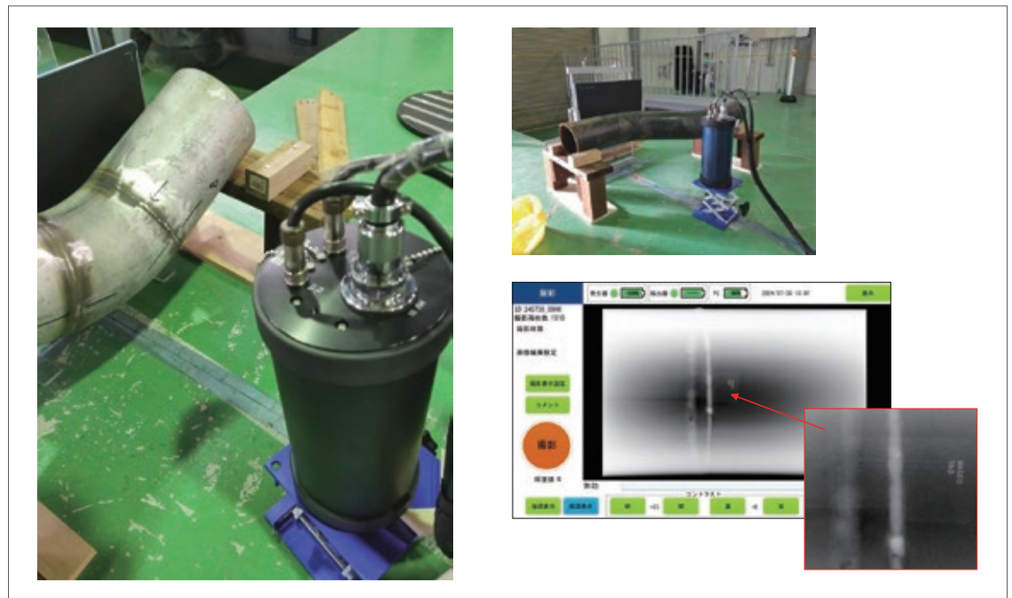
図7 産業分野 X線検査システム (配管溶接)
