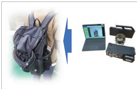
図5 リュック収納式X線検査システム
