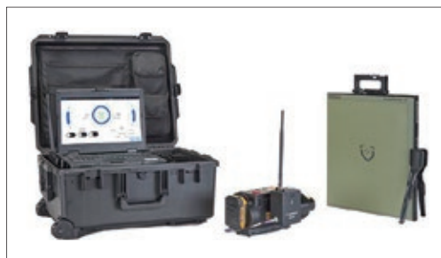
図2 海外における X 線爆発物検査装置 (MP-SEC)
