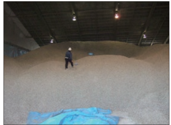
図3 倉庫内に平置きされた木質ペレット
