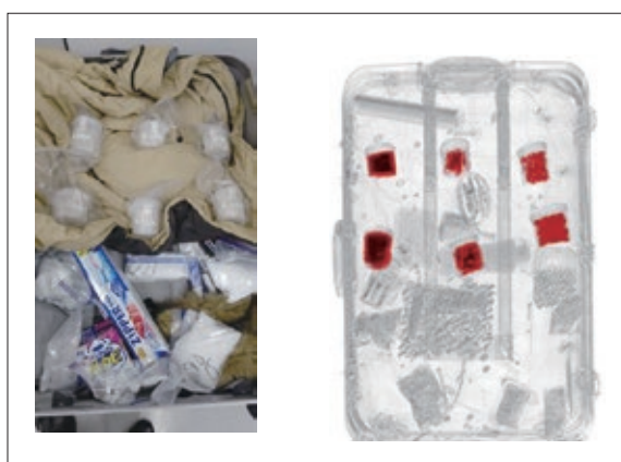
図6 X線CT装置による薬物探知画像
